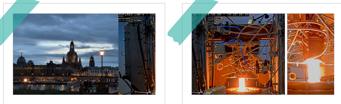
드레스덴 구시가지 전경과 드레스덴공과대학 항공우주공학과에서 수행한 과산화수소-케로신 에어로스파이크 이원추진제 로켓 엔진의 연소 시험 장면 (출처: 드레스덴공과대학 항공우주공학과)
