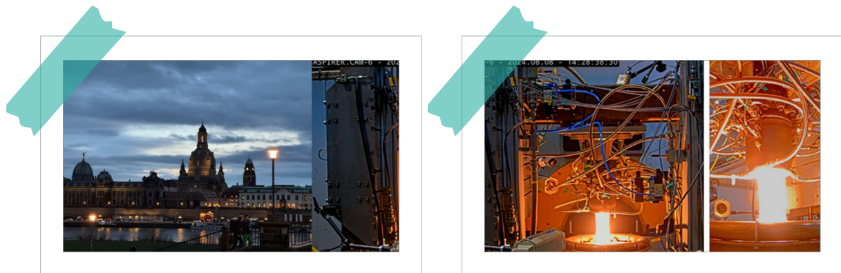
드레스덴 구시가지 전경과 드레스덴공과대학 항공우주공학과에서 수행한 과산화수소-케로신 에어로스파이크 이원추진제 로켓 엔진의 연소 시험 장면 (출처: 드레스덴공과대학 항공우주공학과)
